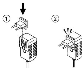
Schließen Sie (wie unten dargestellt) das Batterieladegerät an die Batterie an und stecken Sie es in die Steckdose.
