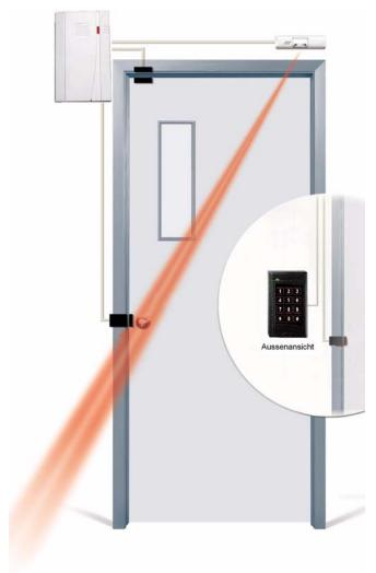
**Türgriff.** Die Außentürgriff (oder Drehknopf) sollte permanent verschlossen bleiben. Der Zugangskontroller sollte immer derjenige sein, der die Tür durch Entriegelung des elektrischen Schlosses öffnet. Der innere Türgriff sollte frei (unverschlossen) sein, um einen ungehinderten Ausgang in einer Notsituation zu erlauben. Um zu vermeiden, dass die Tür manuell offen steht, stellen Sie Sicher, dass es keine Verriegelungs-/Entriegelungsknöpfe, am inneren Türknopf vorhanden sind.
