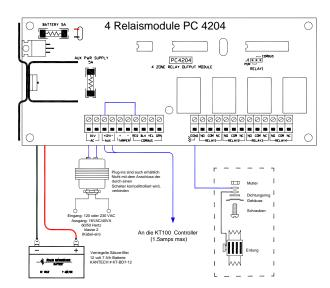
6. Setzen Sie die Batterie im Schrank ein.. Falls die AC- Versorgung vom PC4204 entfernt wurde, wird die Sicherungsbattierie 12 Volt (vollständig geladen), einer normalen Betriebsdauer bis zu 12
